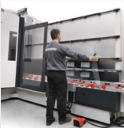
Ausstattung mit Losrollen am Maschineneingang, mit der Möglichkeit sie zu motorisieren.
