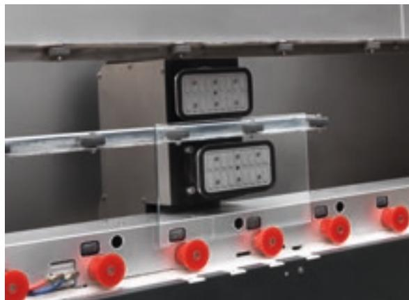
Spezifische optionale Technologie für die Bearbeitung von Glasplatten mit kleineren Abmessungen bis zu 300x200 mm und 300x150 mm. Die Bearbeitung wird mit Schleifscheiben mit 80 mm ohne Zuhilfenahme des Pilotsystems durchgeführt.
